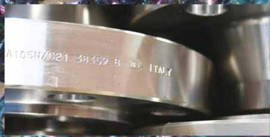
La disponibilità di macchinari moderni e di attrezzature adeguate permettono di ottenere un prodotto che, dopo le diverse procedure di lavorazione, può essere sottoposto alle più severe prove di collaudo. Le fasi di ricezione materiali, taglio, riscaldo, forgiatura, trattamento termico, lavorazione meccanica, marcatura ed imballo sono eseguite in accordo al Sistema di Qualità che interviene nelle diverse fasi di fabbricazione, ed è certificato UNI EN ISO 9001:2008.
